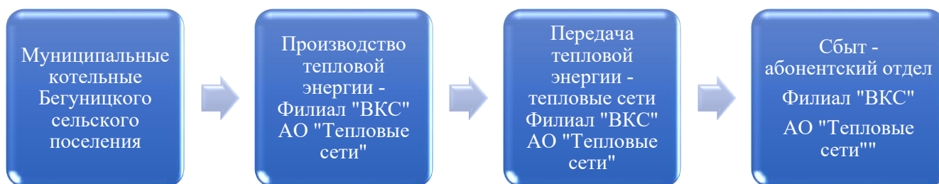
Рисунок 2. Функциональная структура теплоснабжения Бегуницкого сельского поселения (структура договорных отношений между теплоснабжающими и теплосетевыми организациями)
