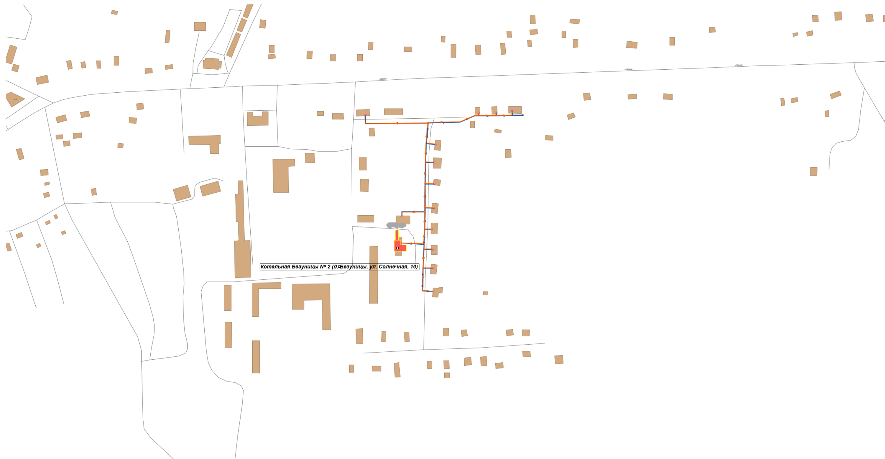
Рисунок 4. Схема расположения тепловых сетей от котельной № 2, д. Бегуницы, ул. Солнечная, 10 филиал «ВКС» АО «Тепловые сети» Бегуницкого сельского поселения
